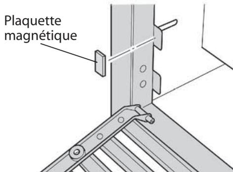
3. Installez les deux sections des côtés en les accrochant dans l'encadrement du foyer.
