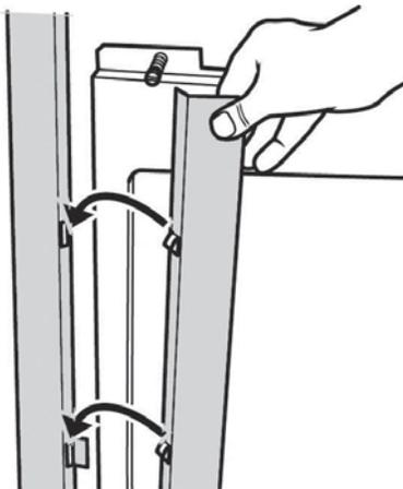
4. Installez la grille de protection en accrochant d'abord les crochets du bas à la base des sections des côtés; puis accrochez le haut de la grille en poussant sur ses coins supérieurs pour que ses languettes s'enclenchent aux bords supérieurs des sections des côtés.
