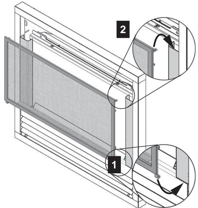
5. Insérez le bord inférieur du registre du haut derrière la grille puis accrochez le registre aux languettes de l'encadrement du foyer.
