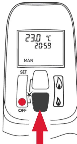
La télécommande est maintenant prête à être utilisée. Cette procédure n'est effectuée qu'une seule fois avant d'utiliser la télécommande. La synchronisation n'est pas affectée par le changement des piles.
