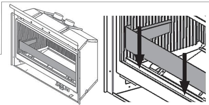
2. Placez la base de céramique sur le support derrière le brûleur. Le bas de la base doit reposer contre le rebord du support.
