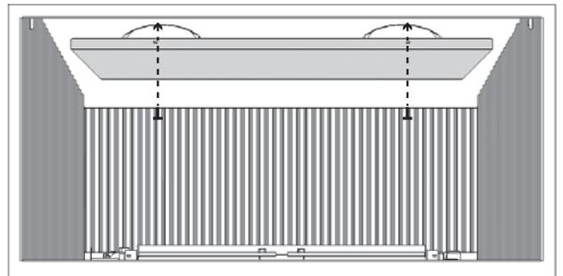
Déballez les éléments du lit d'alimentation de céramique avec précautions car ils sont fabriqués d'un matériau fragile. Installez les différents éléments selon les directives suivantes. Veuillez noter que la **position appropriée des pierres et morceaux de bois (si utilisés) est essentielle au bon rendement de l'appareil.**
