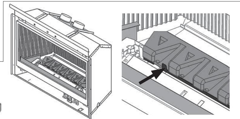
3. Installez la plateforme de céramique dans la boîte de foyer en pivotant d'abord l'avant afin de l'insérer derrière le support de plateforme. Pivotez ensuite l'arrière de la plateforme contre le panneau de céramique arrière en faisant attention de ne pas égratigner le panneau.
