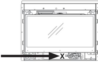
Utilisez seulement de nouvelles conduite de fer noir, d'acier ou de cuivre si acceptable—vérifiez les codes locaux. **Notez qu'aux États-Unis, les conduites de cuivre doivent être étamées aux fins de protection contre les composés sulfuriques.**
