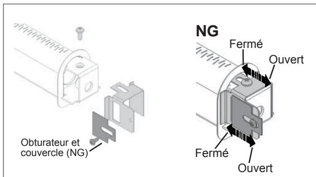
Cependant, dans certains cas inhabituels, l'aspect des flammes peut être amélioré en changeant le réglage de l'aération. La nécessité de réglage devrait être déterminée seulement après avoir fait fonctionner l'appareil avec les bûches et panneaux de céramique et avec la fenêtre installés.
