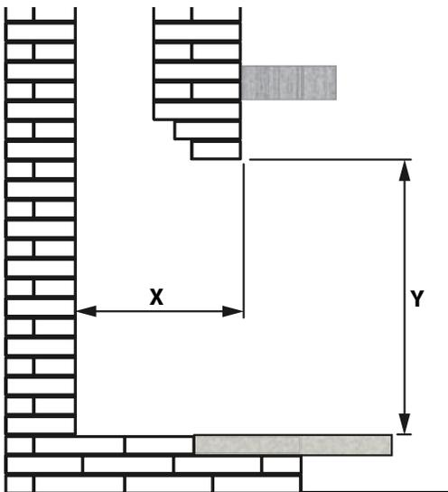
Assurez-vous que la saillie de béton dans le foyer n'empiète pas sur les dimensions requises pour l'installation ou pour le conduit d'évacuation.
