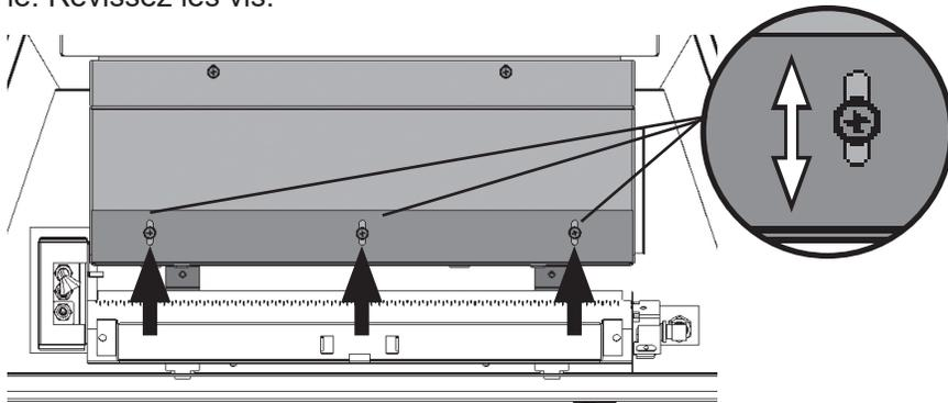
Le déplacement du rebord vers l'avant produira plus d'empiètement/lueur/hauteur de flammes **sur le côté gauche des bûches**; le déplacement du rebord vers l'arrière fera le contraire.
