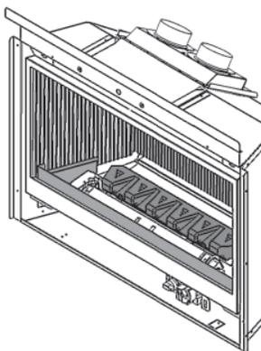
3. Installez la plateforme de céramique dans la boîte de foyer en pivotant d'abord l'avant afin de l'insérer derrière le support de plateforme. Pivotez ensuite l'arrière de la plateforme contre le panneau de céramique arrière en faisant attention de ne pas égratigner le panneau. **Attention : La plateforme est fragile. NE LA FORCEZ PAS en place afin d'éviter de l'endommager.**
