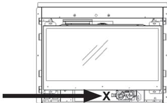
Utilisez seulement de nouvelles conduite de fer noir, d'acier, d'acier inoxydable ondulé (CSST) ou de cuivre si acceptable—vérifiez les codes locaux. **Notez qu'aux États-Unis, les conduites de cuivre doivent être étamées aux fins de protection contre les composés sulfuriques.**
