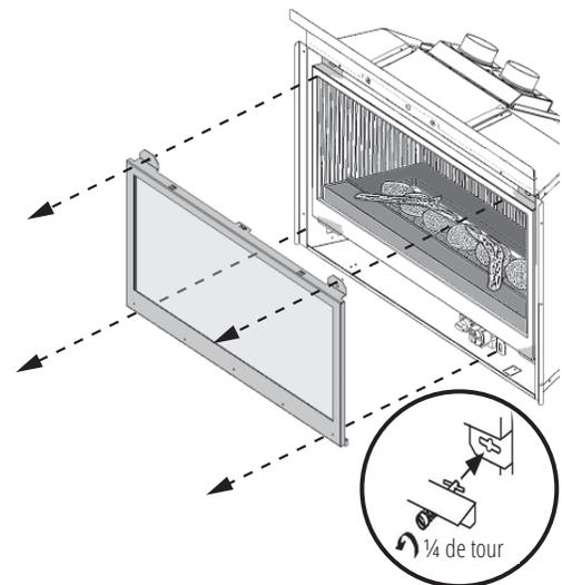
3. Tirez sur le bas de la fenêtre et décrochez-la de la boîte de foyer en la soulevant.
