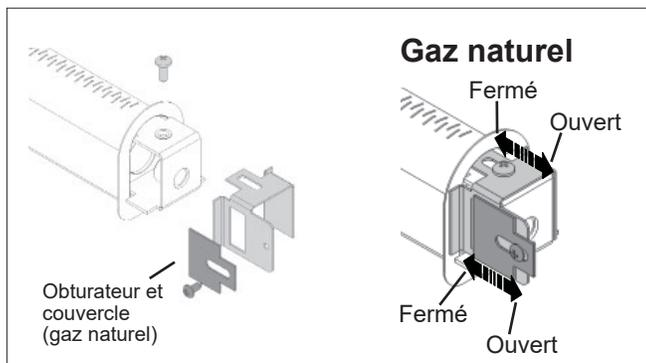
Dépendamment du lit d'alimentation utilisé, de l'altitude et autre considérations, l'aspect des flammes peut être amélioré en changeant le réglage de l'aération. La nécessité de changer l'aération devrait être déterminée seulement après avoir fait fonctionner l'appareil avec le lit d'alimentation, les panneaux et la fenêtre installés et évalué les flammes suivant un réchauffement de 15 minutes.
