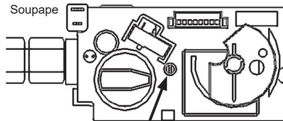
Ajustement de pression d'admission derrière le capuchon de plastique
