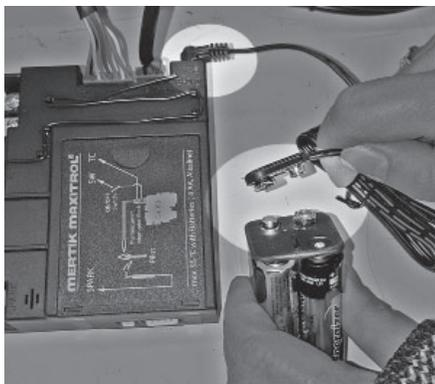
5. Remplacez le récepteur et le porte-piles sous la boîte de foyer.
