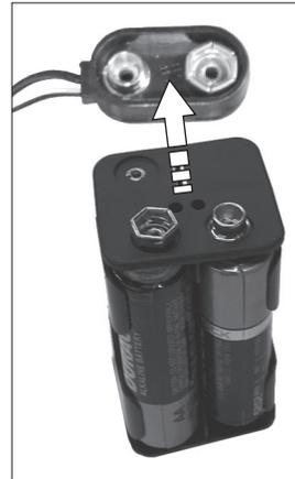
3. Remplacez les piles par 4 piles **alcalines** AA 1.5V.
