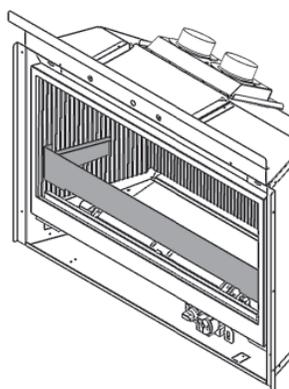
2. Placez la base de céramique sur le support derrière le brûleur. Le bas de la base doit reposer contre le rebord du support.
