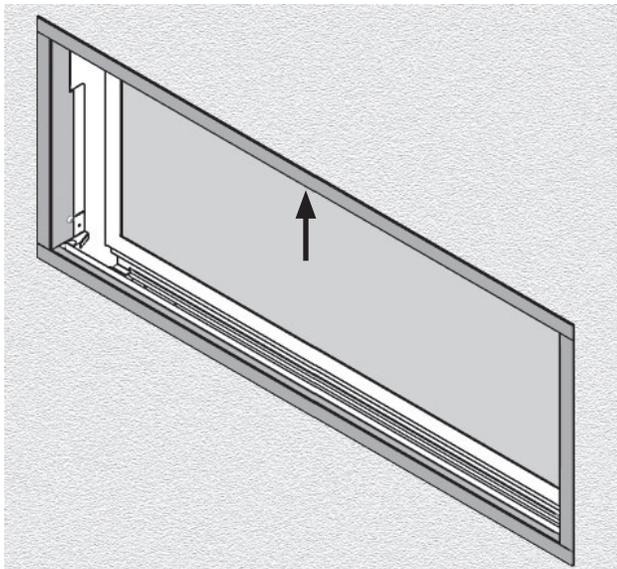
4. Placez la plinthe dans l'espace entre la fenêtre et la bordure. Alignez les découpures rondes de la plinthe aux trous des supports en-dessous tel qu'indiqué.
