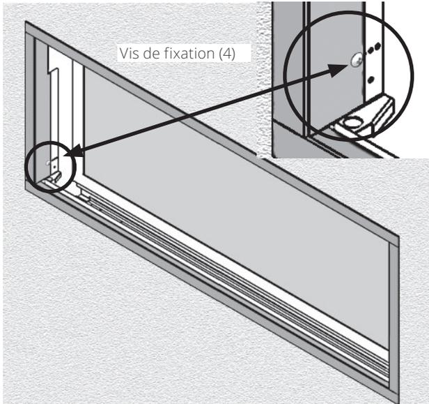
3. Fixez le haut de la bordure à l'appareil en insérant une vis courte dans la fente au milieu de la bordure. Ceci empêchera la bordure d'arquer lorsque chauffée.
