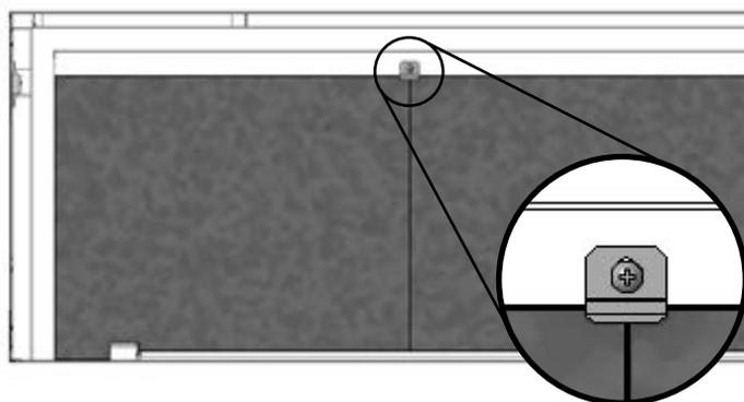
d'ancrage à l'endroit où les deux panneaux se joignent tel qu'indiqué.
