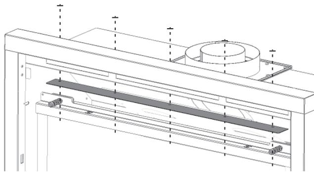
2. Placez la plaque de finition sur l'encadrement noir du foyer et fixez-le aux quatre languettes avec deux vis par côté.
