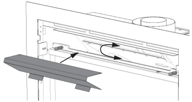
4. Placez le panneau d'accès à l'horizontal sous le pare-étincelles et insérez les chevilles de chaque côté du cadre de la devanture dans les encoches du panneau. Pivotez le panneau vers le bas.
