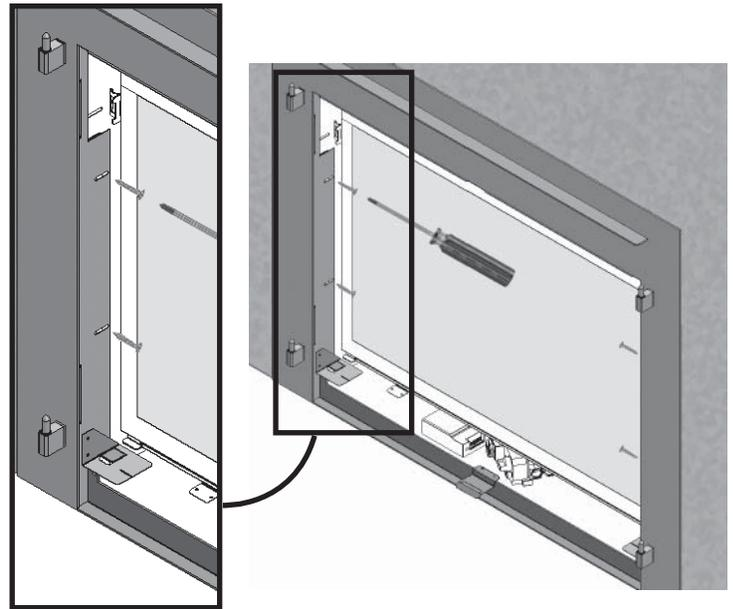
4. Insérez le panneau amovible sous les attaches des supports horizontaux des côtés et poussez le panneau jusqu'à ce qu'il soit égal à la surface de la plaque.
