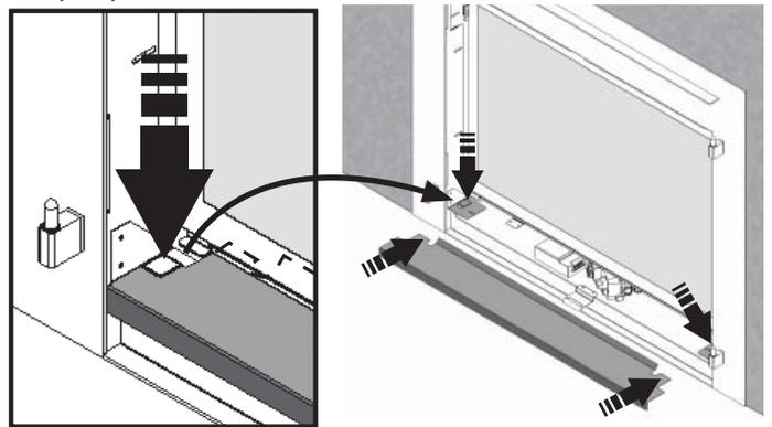
5. Ajustez la position du déflecteur de convection de chaque côté de la fenêtre. Dévissez l'écrou, tirez le déflecteur le plus en avant possible, resserrez l'écrou.
