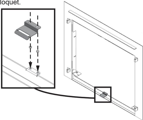
3. Enchâsssez la bordure dans l'ouverture de la caisse du foyer en plaçant ses supports des côtés contre les 4 supports de montage de la caisse. Fixez sommairement la bordure avec 4 vis à profile bas. Ajustez la position de la bordure contre la finition du mur et serrez les vis.
