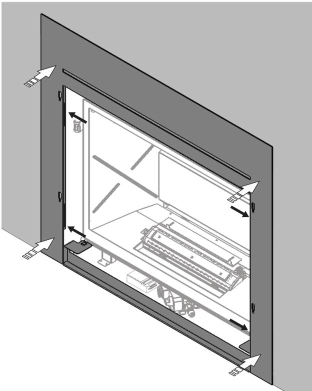
2. Insérez le panneau amovible sous les attaches des supports des côtés et poussez le panneau jusqu'à ce qu'il soit égal à la surface de la plaque.
