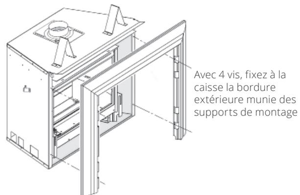
Avec 4 vis, fixez à la caisse la bordure extérieure munie des supports de montage
