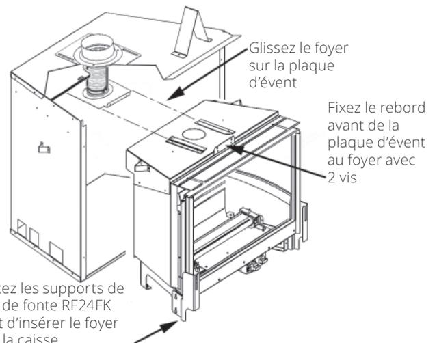
Montez les supports de base de fonte RF24FK avant d'insérer le foyer dans la caisse
