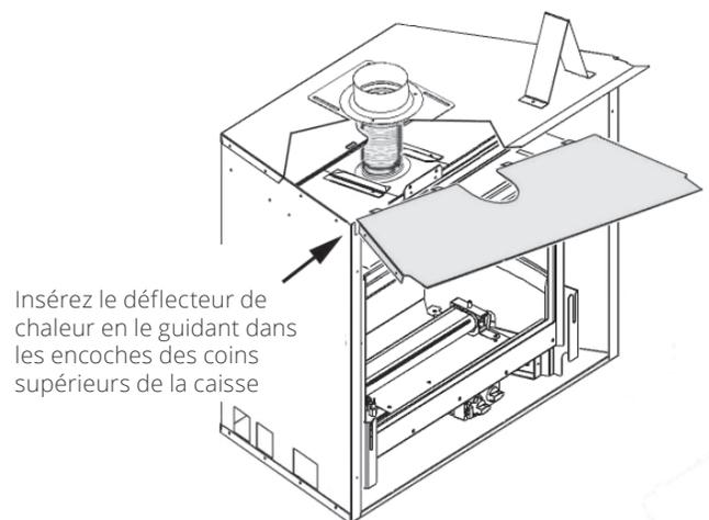
Insérez le déflecteur de chaleur en le guidant dans les encoches des coins supérieurs de la caisse
