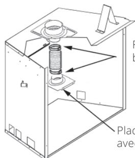
Fixez le conduit souple aux buses à l'aide de serre-joints
