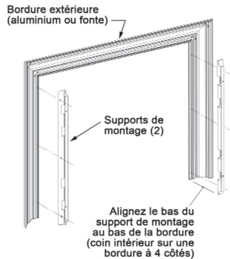
1. Fixez les supports de montage fournis avec le kit à dégagement zéro à l'arrière de la bordure extérieure. **Note :** Il est possible que la bordure nécessite une extension pour couvrir l'ouverture de l'âtre jusqu'au mur combustible. Des pièces de métal taillées sur mesure peuvent être ajoutées à la bordure en les fixant à la rainure de vis située à l'arrière de la bordure.
