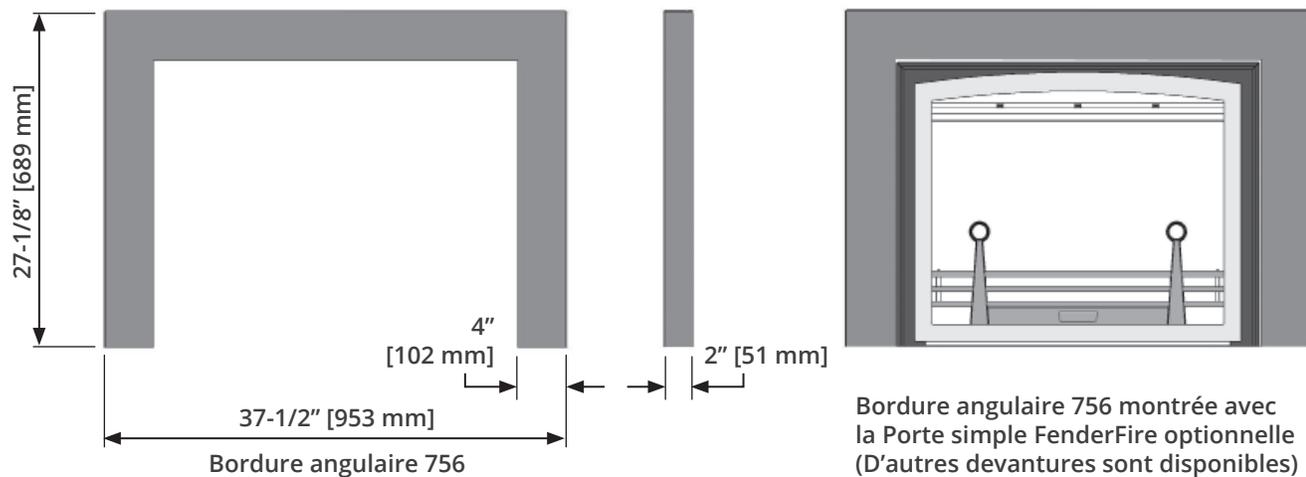
La Bordure angulaire à trois côtés 756 peut être installée sur les foyers encastrables Valor G3 738 et 739 de même que sur les foyers Retrofire RF24B lorsqu'installé dans la Caisse à dégagement zéro RA24ZC.
