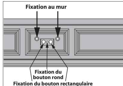
5. Le bouton rectangulaire peut être fixé à la bordure après son installation. Fixez les vis fournies à l'arrière du bouton. Accrochez le bouton à la bordure dans les trous de serrures au centre de la section du haut.
