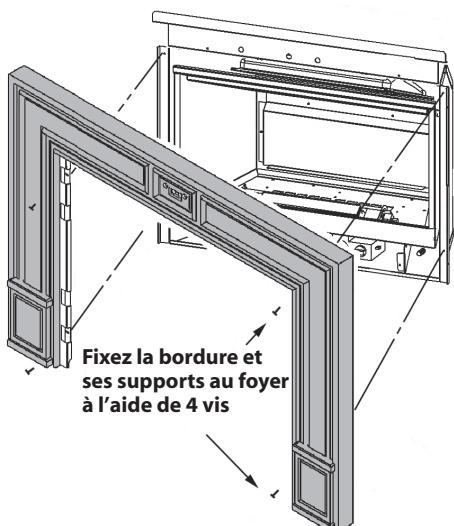
**NOTE :** Dans le cas où la bordure doit être solidifiée, fixez-la au mur à l'aide de 2 vis en utilisant les points de fixation les plus à l'extérieur du centre de la section du haut. Une plaque de soutien ou des chevilles d'ancrage (non incluses) peuvent être requises.
