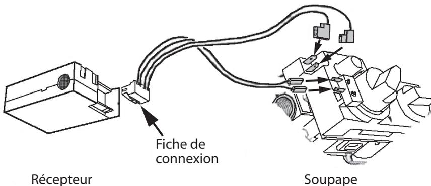
**MISE EN GARDE! Ne placez pas les piles dans le récepteur jusqu'à ce que ses fils soient branchés à la soupape. Un court-circuit pourrait se produire et détruire les composants électrique.**
